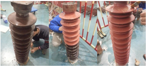
图 11 支柱绝缘子 RTV 不同涂刷配置方式
